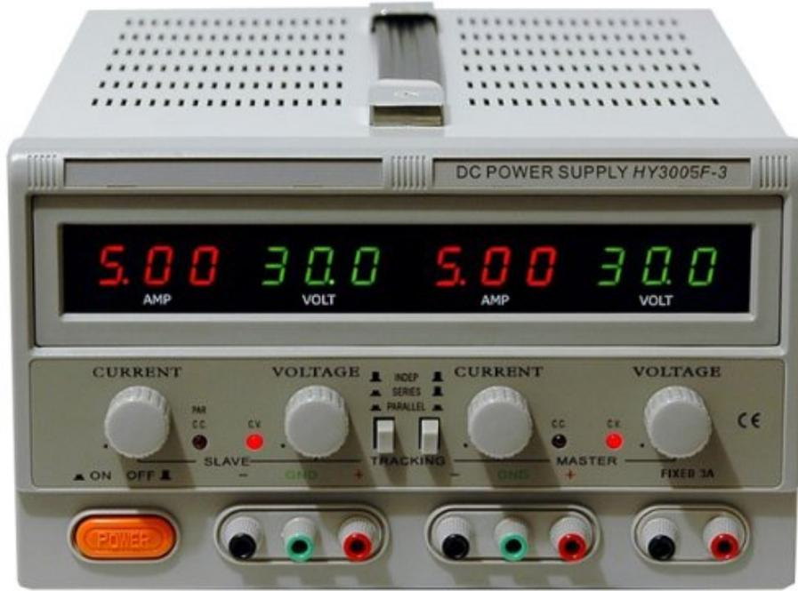
شكل 6: جهاز توليد التيار المستمر DC Power Supply
