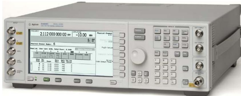
شكل 9: جهاز مولد الاشارة Signal Generator
